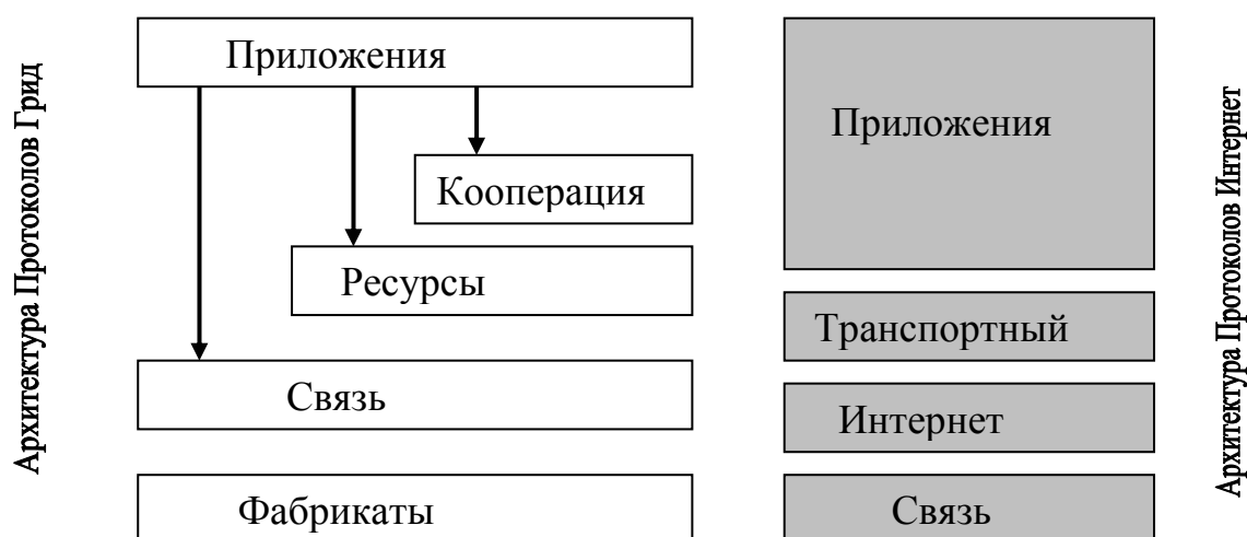
Рисунок 2: Многоуровневая грид-архитектура и её соотношение с Интернет-архитектурой протоколов. Поскольку Интернет-архитектура протоколов простирается от сетевого уровня до прикладного, здесь показано отображение из грид-уровней в Интернет-уровни.
